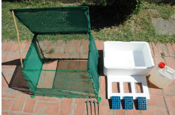
Figura 9. Esempio del materiale necessario per l'allestimento delle stazioni di rilevamento di bioindicazione dell'ozono.
