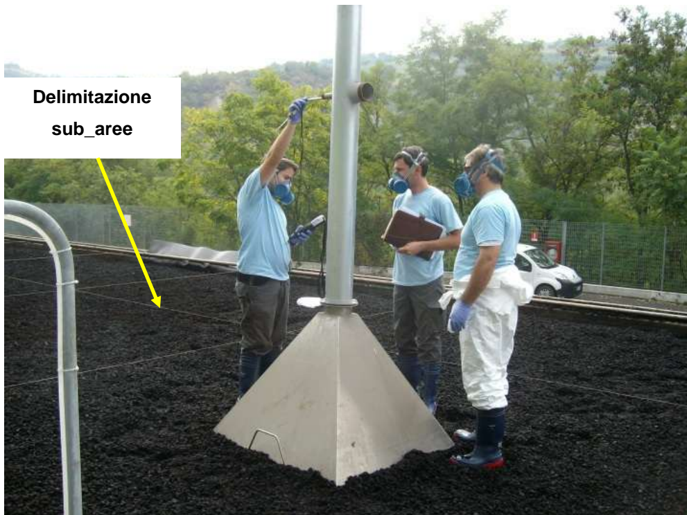
FOTO 22: campionamento sulla superficie del biofiltro E3. (27/09/11)
