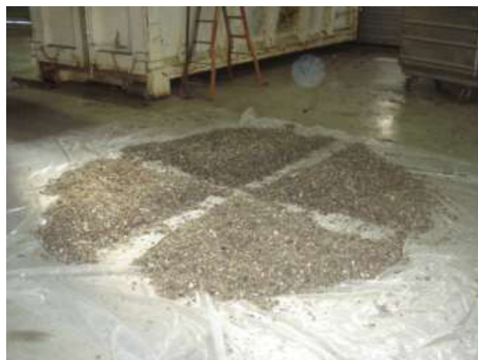
FOTO 15: riduzione volumetrica: quartatura.
